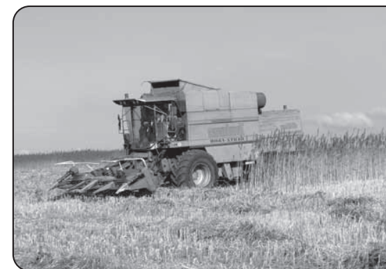
Speciálně upravený kombajn DEUTZ FAHR 4080 HTS pro kombinovanou sklizeň konopí
